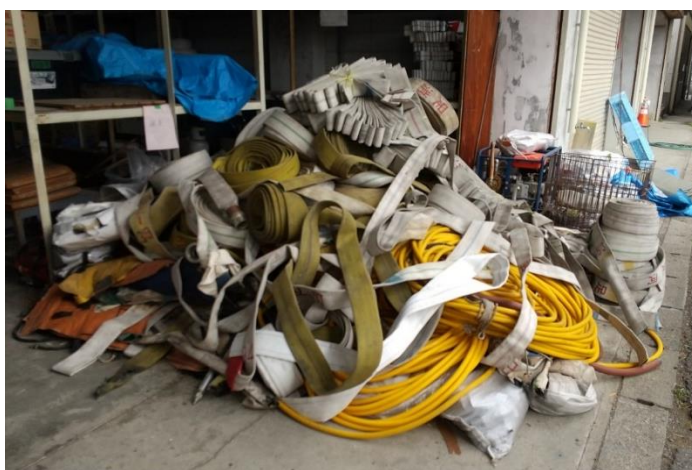
・ 焼損したホース
