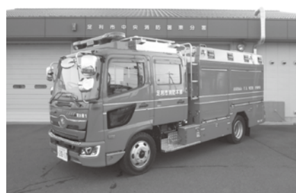
▲東分署に配備された水槽付消防ポンプ自動車
